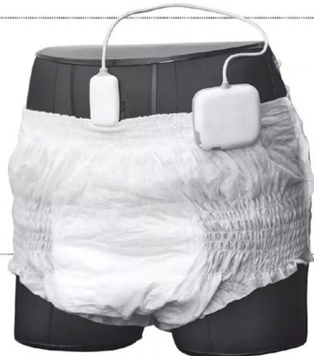
「DFree」の装着イメージ(上)。下腹部に超音波ユニットを貼り、バッテリーはパンツのゴム部分に装着。バッテリーはUSB(左)から充電できるので、汎用性も高い
